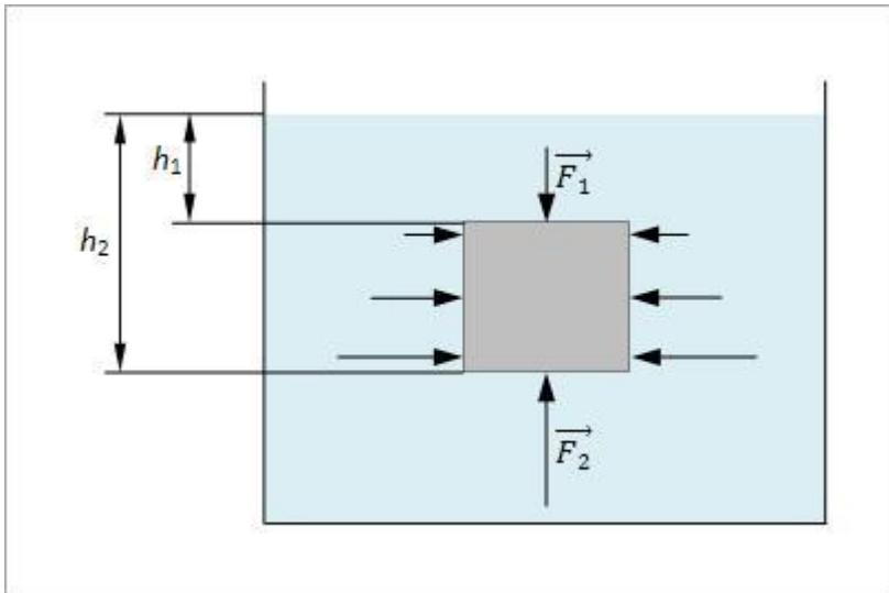
Na bočnim stranama sile su uravnotežene. Na gornju površinu deluje sila  $F_1$ , koja potiče od hidrostatičkog pritiska na dubini  $h_1$ . Na donju površinu deluje sila  $F_2$ , koja potiče od hidrostatičkog pritiska na dubini  $h_2$ .
